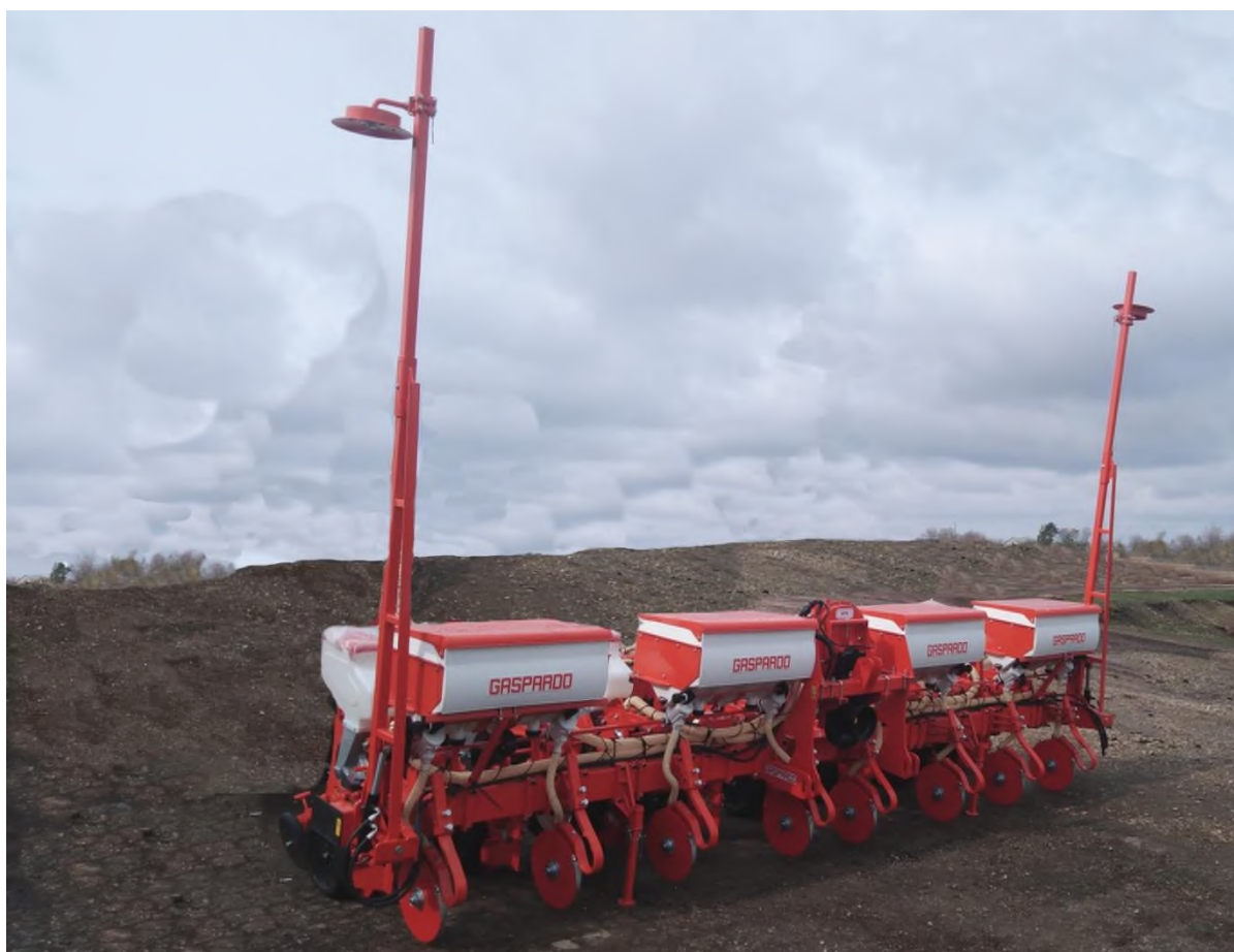
Пневматическая сеялка точного высева Gaspardo MTR-8.
