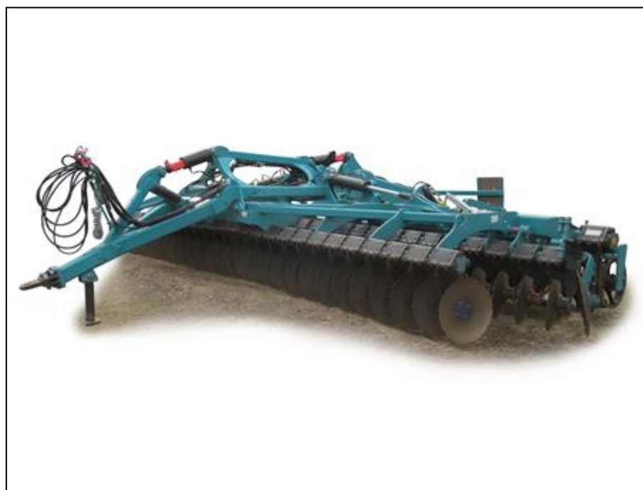
Луцильник дисковый тяжелый складной М-7000ПС "Мастер"
