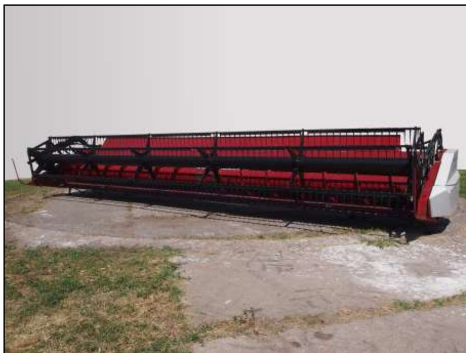
Жатка для уборки зерновых культур с выдвижным столом РСМ-161.81
