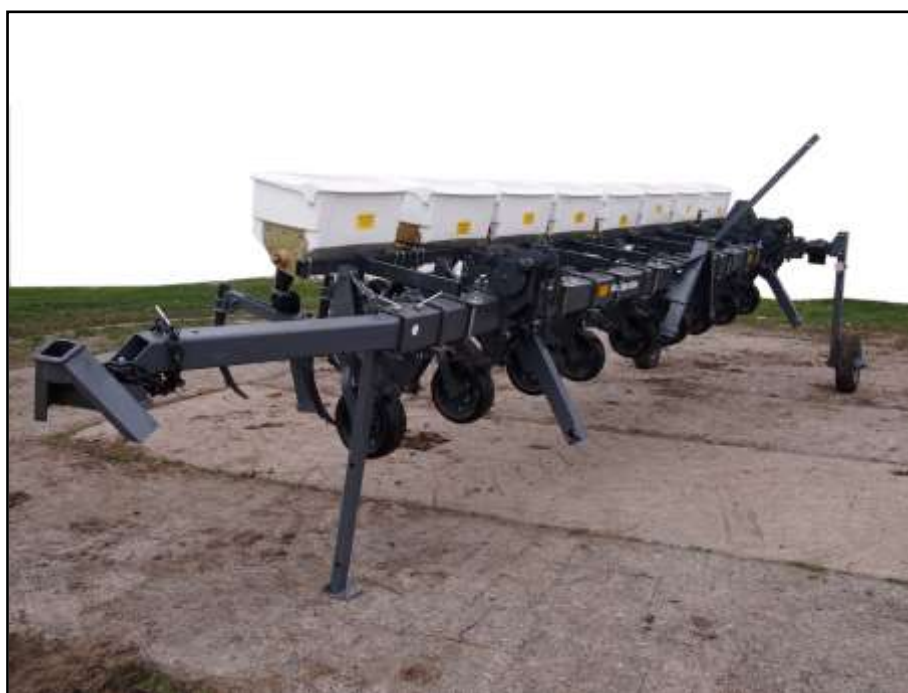
Культиватор навесной для высокостебельных культур КРН-5,6В
