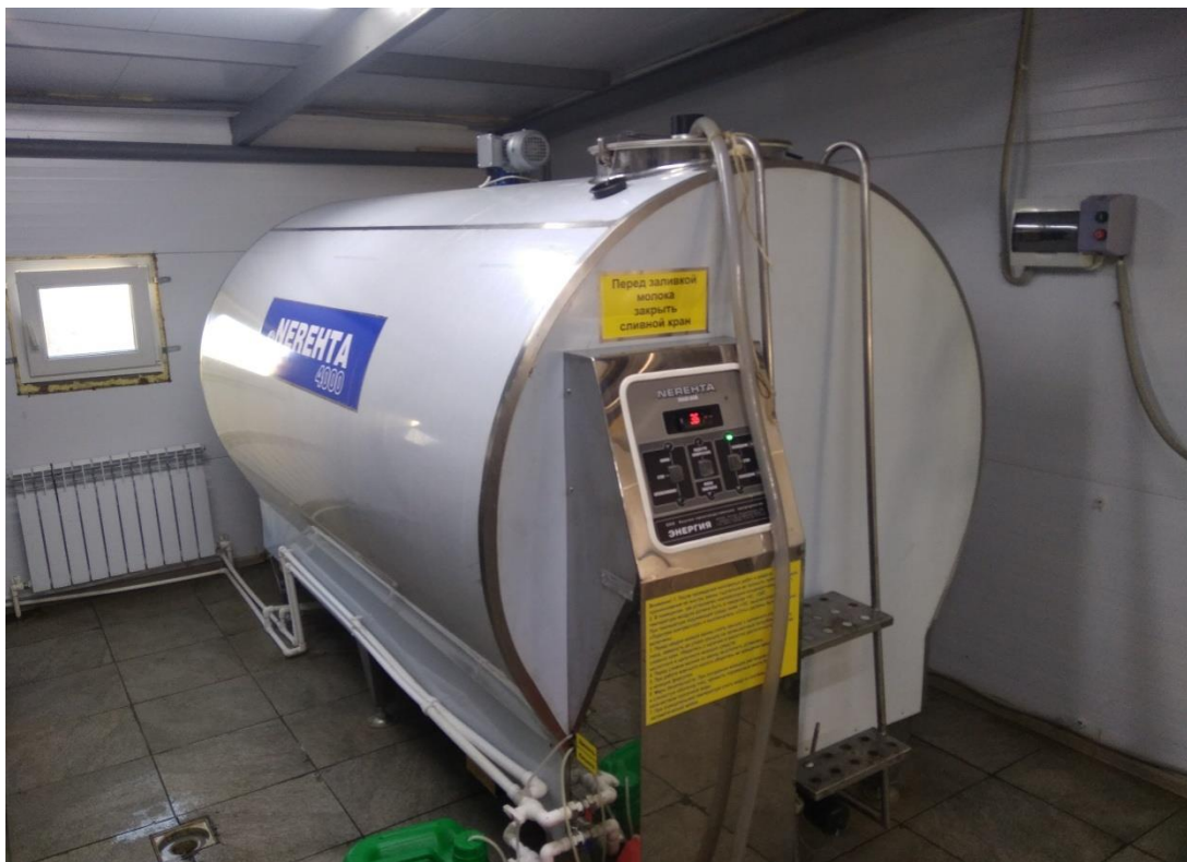
УСТАНОВКА ДЛЯ ОХЛАЖДЕНИЯ МОЛОКА ЗАКРЫТОГО ТИПА УОМТЗ- 4000 NERENTA
