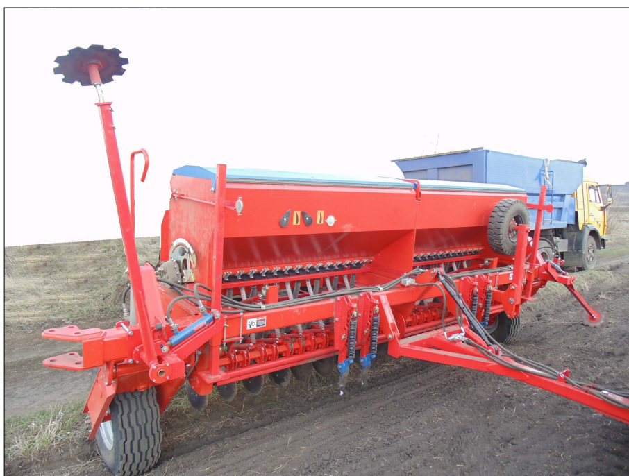
Сеялка зернотуковая МЕРКУРИЙ СЗТ-4
