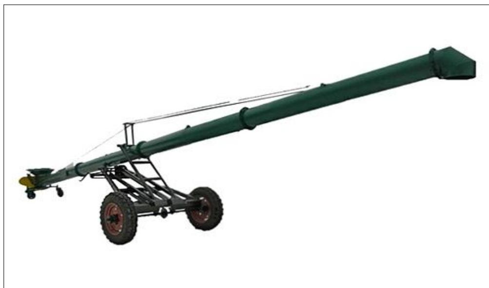
**конвейера винтового передвижного КВП-15**
