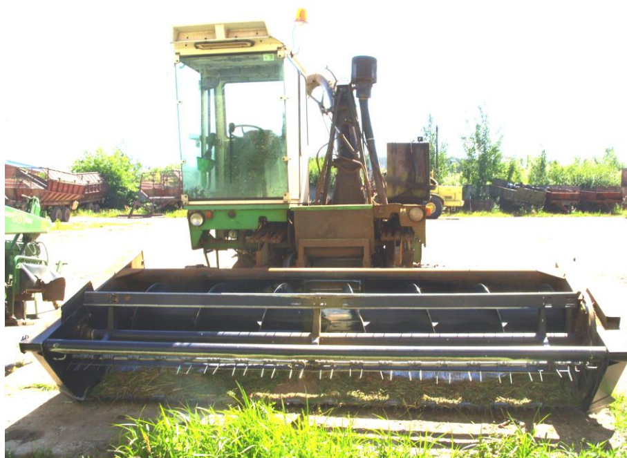
Жатка для уборки кормовых культур S-42 (в агрегате с комбайном Е-281 «Марал-125»)
