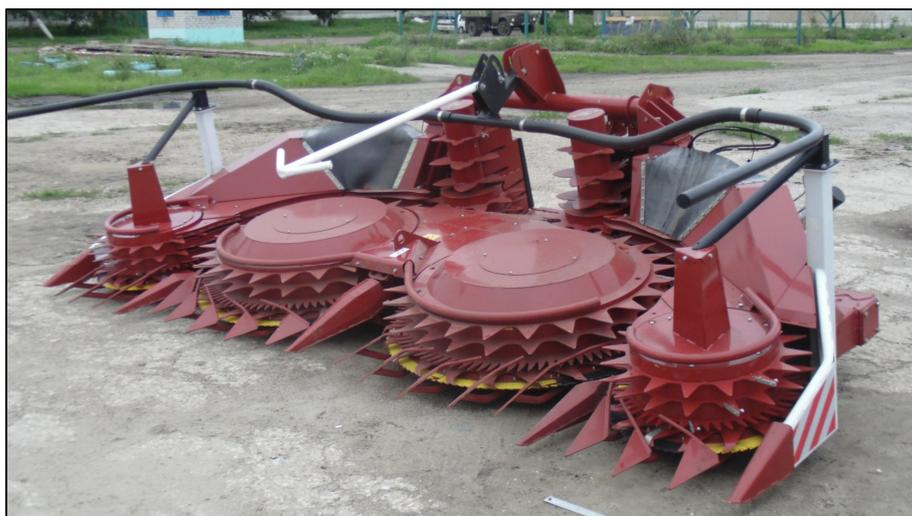
**жатки роторной ЖР-750 «Maize Header 450»**
