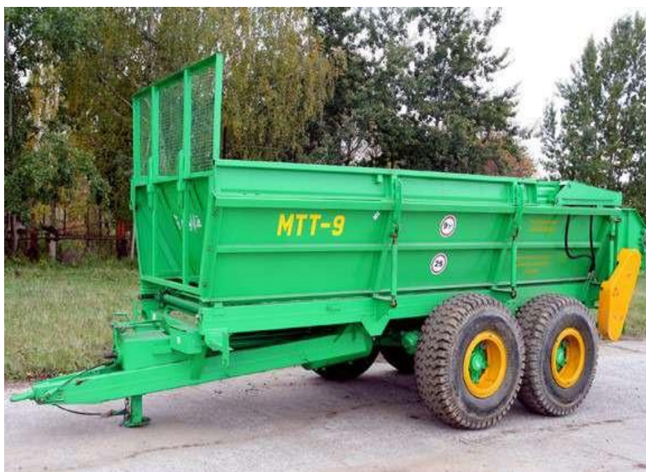
Машина для внесения твёрдых органических удобрений МТТ-9
