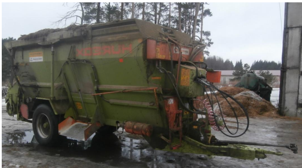
Измельчитель-смеситель раздатчик кормов ИСРК-15Ф «Хозяин»
