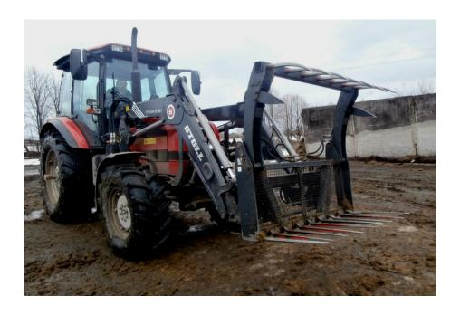
Погрузчик фронтальный FZ 30.1 ProfiLine в агрегате с трактором Беларус 1523.
