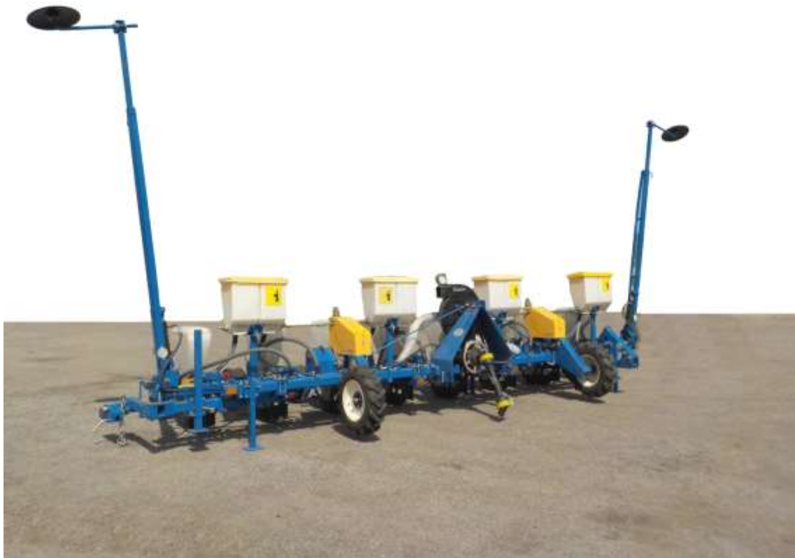
Сеялка навесная пропашная пневматическая СНПП-5,6К.
