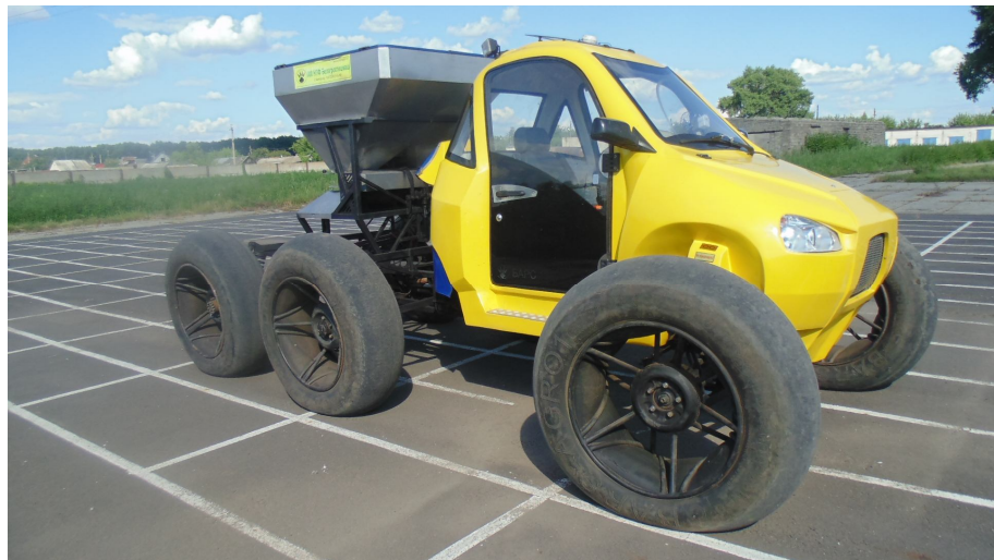
Разбрасыватель минеральных удобрений центробежный дисковый РЦД-1,0
