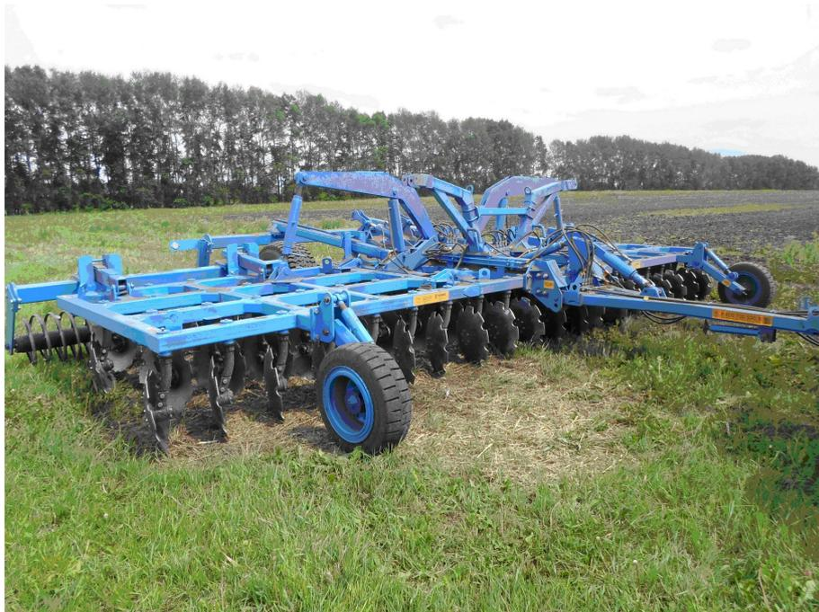
Борона дисковая полуприцепная модернизированная
